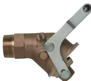
08552 válvula de compuerta de latón para bidones; líquidos viscosos como adhesivos, pintura o aceites pesados por encima de 2000 SSU (aceites alrededor de 30W)
