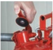
A porta de enchimento rápido do AccuFlow™ do Tipo II possui uma alavanca de levantamento de design ergonómico que se abre para um enchimento fácil.
