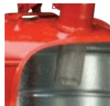
L'arrête-flamme en acier inoxydable évite les retours de flamme. Sa longueur de 88 mm permet d'insérer la buse d'essence de manière sûre et sécurisée.
